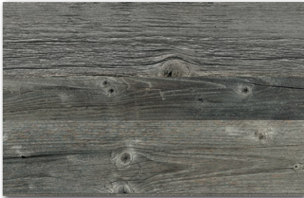
Fichte 5C (roh, unbehandelt) 1,4 Sonnerverbrannt, leicht gebürstet und in Handarbeit mit Echtholz ausgeflickt.
