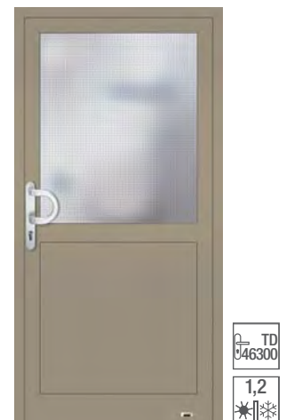
K38500 mit nach unten versetzter Quersprosse, Ver- glasung: Wärmeschutzisoliertglas, vorne: VSG beschichtet, hinten: Float, Mastercarre oder Chinchilla weiß, unten wärmegeädmmtes Alu-Sandwich-Paneel, 30 mm stark, Ober- fläche: Metallic-Feinstruktur Beige.
