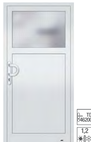
K38400 mit 100 mm Quersprosse, Verglasung: Wärmeschutzisoliertglas, vorne: VSG beschichtet, hinten: Float, Mastercarre oder Chinchilla weiß, unten wärmegeädmmtes Alu-Sandwich-Paneel, 30 mm stark, Ober- fläche: RAL 9016 Verkehrsweiß.
