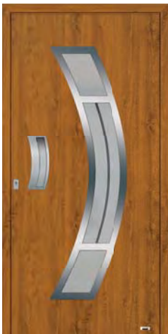
D35400 Griffschale eingelassen, Verglasung: Wärmeschutzisolierglas, vorne: VSG, Mitte: Float mattiert mit klarem Streifen, hinten: Float beschichtet, Holzdekor: Golden Oak.
