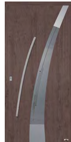
D35700 Stoßgriff auf Füllung montiert, Verglasung: Wärmeschutzisolierglas, vorne: VSG mattiert mit klaren Streifen und Punkten, hinten: Float beschichtet, Holzdekor Siena Noce.
