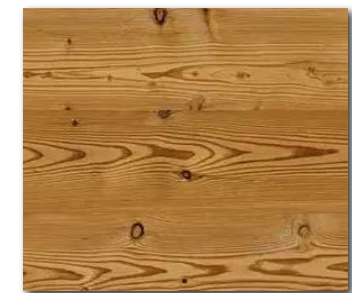
LÄRCHE ALT (geölt) 1,2,3 Unterdach-Bretter, leicht gebürstet und in Handarbeit mit Echtholz ausgeflickt. Struktur Quer oder Längs.
