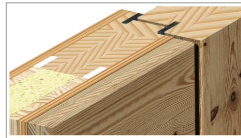
Detail: Standard-Türblatt Rohling mit Massiv-Altholz Applikation
