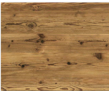
Fichte 3B (roh, unbehandelt) 1,3 Sonnerverbrannt, leicht gebürstet und in Handarbeit mit Echtholz ausgeflickt. Struktur Quer oder Längs.
