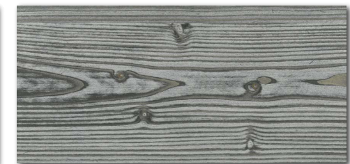
FICHTE ALTHOLZ-EFFEKT GRAU 1 Fichte astig gebürstet, gekratzt, gestechen und mit Aquawood Protor-Finish 2-K lackiert (längs - oder querfurniert)
